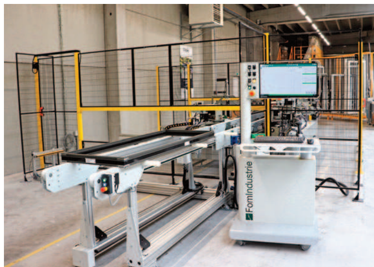
Préparation d'un cadre avant sertissage : pose d'équerres, de colle et étanchéité.
